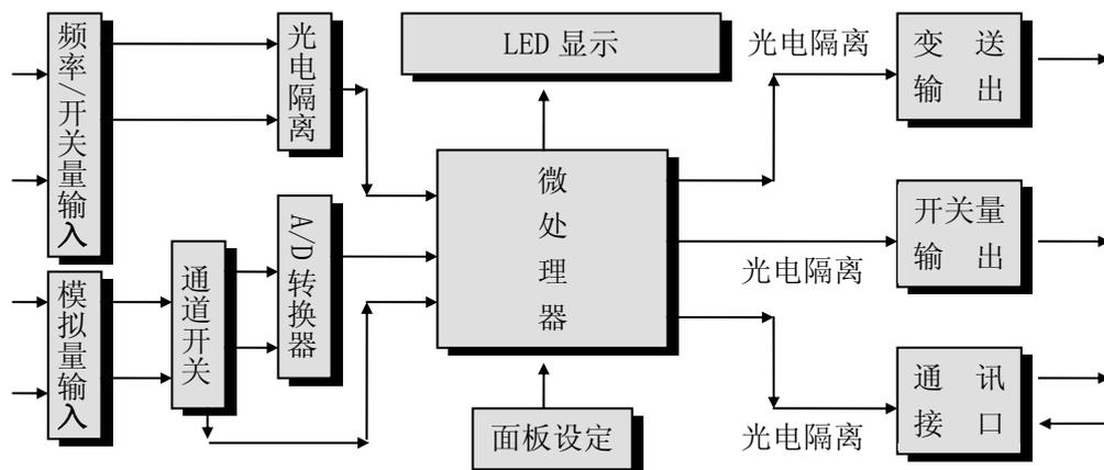
本仪表原理方框图如上，本积算控制仪以单片微处理器为基础，通过输入信号电路把各种模拟信号经A/D转换器转换成数字信号（频率信号直接由微处理器进行计数），微处理器根据采样的结果和数字设定内容进行计算比较后显示及控制输出。
