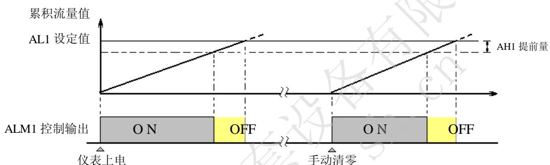
★AL1 定量到控制输出：（自动启动，“0”输出）
