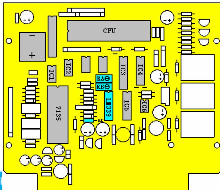
1. 调整输入电压下限：测量 LM339 的第 9 脚，调整电位器 RX，使 LM339 第 9 脚的电压等于输入电压下限值（正旋加大，反旋减少）。
