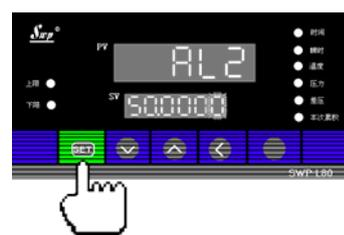
按压SET键，确认参数设定值正确并进入下一参数设定，第一报警参数设定即告完毕。
