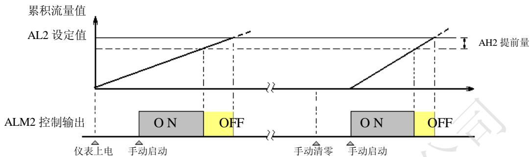
★ AL2 定量到控制输出：（手动启动，“0”输出）
